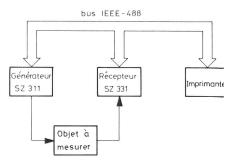
Schéma bloc d'un système de mesure automatique autonome
