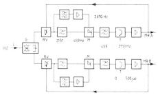
Die Rufumsetzer der Sender sind aus Sicherheitsgründen doppelt ausgeführt.
