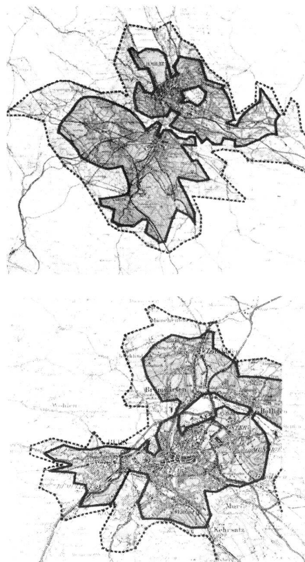
Versorgungsbereich Ortsrufnetze Zürich (oben) und Bern (unten). In den inneren Zonen beträgt die Feldstärke mehr als 1 mV/m, in den äusseren zwischen 0,3 und 1 mV/m (reproduziert mit Bewilligung des Bundesamtes für Landestopografie vom 2. Februar 1982).
