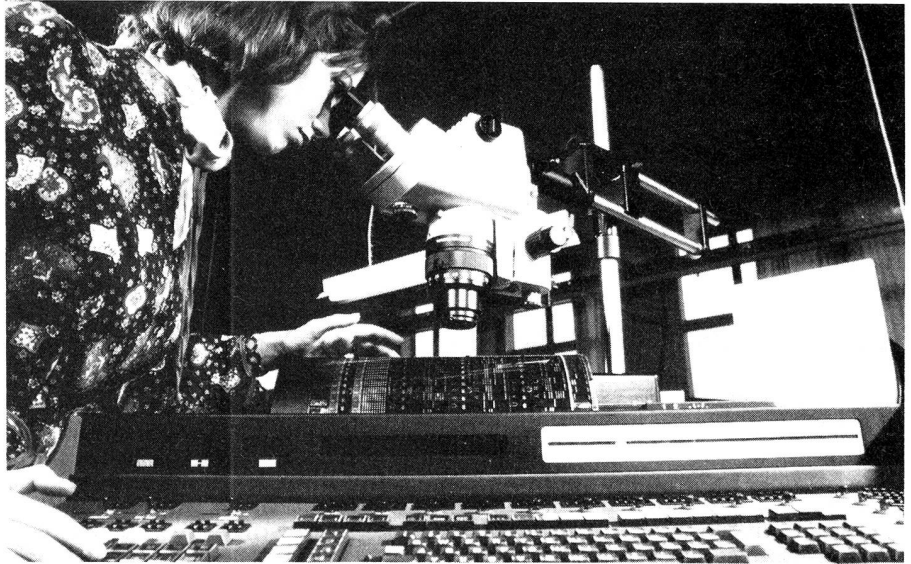
Ein einzigartiges Programm auf dem Weltmarkt hat Wild Heerbrugg mit seinen Makroskopen geschaffen. Das Epimakroskop Wild M450 wurde speziell für anspruchsvolle Untersuchungsaufgaben in der Elektronikindustrie entwickelt.
