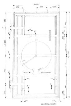
Die neuen abgeschirmten Türen von Elektro-Winkler & Cie AG eignen sich für NEMP-abgeschirmte Räume und erreichen gute Dämpfungswerte.
