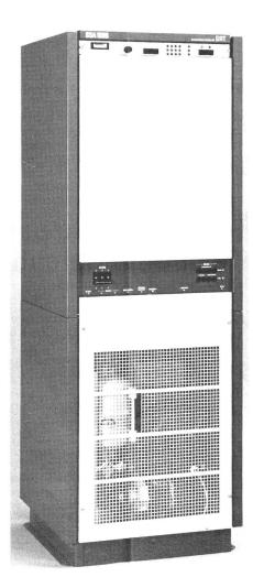
Die 1 kW-Endstufe SSA1000 mit Flüssigkeitskühlung lässt sich für die Installation auch in zwei Blöcke aufteilen.
