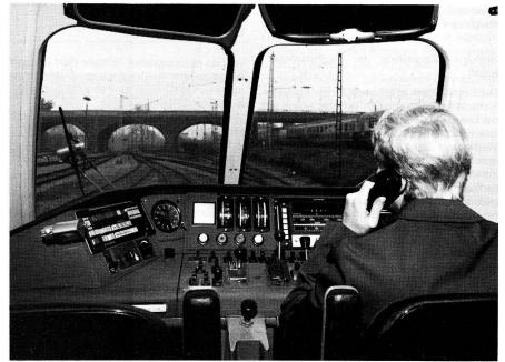
AEG-Telefunken hat über 8000 Triebfahrzeuge und 13000 Streckenkilometer der Deutschen Bundesbahn mit einem Zugbahnfunk-System im 460 MHz-Bereich ausgerüstet. Das Bild zeigt einen Führerstand eines Triebfahrzeuges mit dem Zugbahnfunkgerät (links im Bild).
