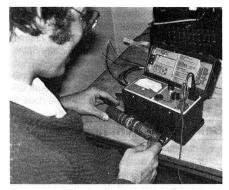
Sektion Bern: Am fachtechnischen Kurs «Draht» machte das Messgerät T-02 einen bedeutend besseren Eindruck als das bisherige «Feldmesskästchen». Jeder Teilnehmer führte vorbereitete Spannungs-, Isolations- und Widerstandsmessungen durch.
