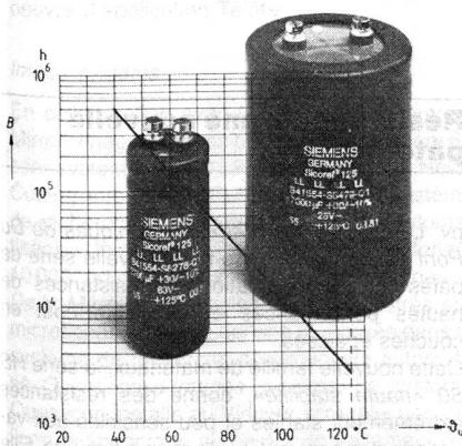
Die zulässige Betriebstemperatur der Long-Life-Elkos «Sicorel 125» von Siemens reicht von  $-55^{\circ}\text{C}$  bis  $+125^{\circ}\text{C}$ . Die Abhängigkeit der Lebensdauer von der Betriebstemperatur konnte soweit gemildert werden, dass die neuen Kondensatoren zum Beispiel bei  $+85^{\circ}\text{C}$  noch eine «Lebenserwartung» von 30 000 Stunden haben.
