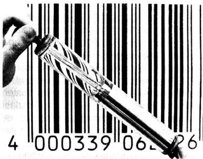
Mit dieser 229 mm langen Laserröhre von Siemens lassen sich die Strichcodes der parallelen Linien unterschiedlicher Breite lesen, welche bereits auf vielen Verpackungen für Lebensmittel oder Konsumartikel aufgedruckt sind. Die bisherige Preisauszeichnung jedes einzelnen Artikels kann mit solchen Scanner an der Ladenkasse künftig ebenso entfallen wie das zeitraubende und zuweilen fehlerhafte Eintippen durch das Verkaufspersonal.
