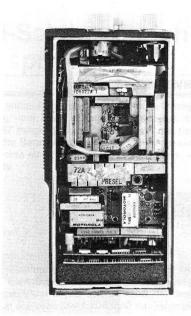
Geöffnetes MX 300 mit integrierter digitaler Verschlüsselung.
