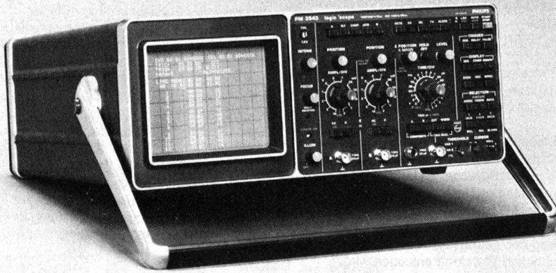
Philips MP 3543: Ein Logikanalysator mit Oszilloskop für gleichzeitige Logik- und Echtzeitanalyse eignen sich für die Fehlersuche in Hardwaresystemen.
