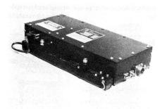
Der Verstärker VZV-6996F6 für den Frequenzbereich 8 bis 18 GHz ist ein kleiner und moder-Breitband-Wanderfeldröhrenverstärker. Das Gerät eignet sich besonders für Störer-, Datenübertragungs- und Radaranwendungen.
