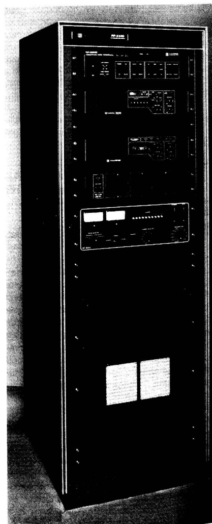
Bild 8: Beispiel einer kompakten Schiffsfunkstation für ARQ-Betrieb. Im Gegensatz zur beschriebenen Hauptstation wird hier nur 1 Sende/Empfangsantenne mit einem schnellen Antennenumschalter verwendet.
