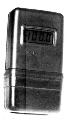
Abb. 1: Aussenansicht des SZ 195. Die Anzeige «-100.0» bedeutet, dass das Gerät in Ordnung arbeitet, aber kein Messsignal anliegt.
