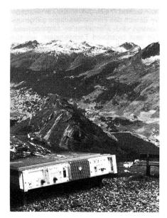
Der VHF-FM-Umsetzer UR 050 erfasst mit seinen drei Sendeleistungen 20 mW, 1 W und 10 W alle denkbaren Anwendungsfälle, angefangen vom Einsatz zu Messzwecken über die Einspeisung in CATV-Systeme oder Schlitzkabel bis hin zur Versorgung kleinerer Gebiete.
