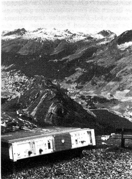
Der VHF-FM-Umsetzer UR 050 erfasst mit seinen drei Sendeleistungen 20 mW, 1 W und 10 W alle denkbaren Anwendungsfälle, angefangen vom Einsatz zu Messzwecken über die Einspeisung in CATV-Systeme oder Schlitzkabel bis hin zur Versorgung kleinerer Gebiete.
