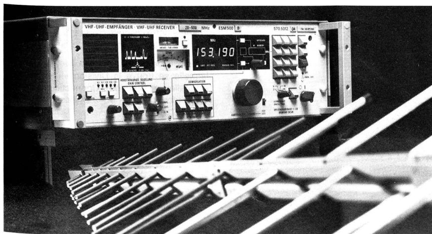
Zur Empfängerserie ESM 500, einer Typenreihe universell einsetzbarer Empfänger für den VHF-UHF-Bereich, gehören breitbandige Tischempfänger mit hohem Bedienungskomfort und – für den Einsatz in rechnergesteuerten Funckerfassungssystemen – preisgünstige Absetzempfänger mit speziell auf bestimmte Funkdienste zugeschnittenen Frequenzbereichen. Das Bild zeigt die Tischversion ESM 500 B mit der zugehörigen logarithmisch-periodischen Breitbandantenne HL 023.
