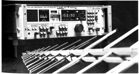
Zur Empfängerserie ESM 500, einer Typrenreihe universell einsetzbarer Empfänger für den VHF-UHF-Bereich, gehören breitbandige Tischempfänger mit hohem Bedienungskomfort und – für den Einsatz in rechnergesteuerten Funkerfassungssystemen – preisgünstige Absetzempfänger mit speziell auf bestimmte Funkdienste zugeschnittenen Frequenzbereichen. Das Bild zeigt die Tischversion ESM 500 B mit der zugehörigen logarithmisch-periodischen Breitbandantenne HL 023.
