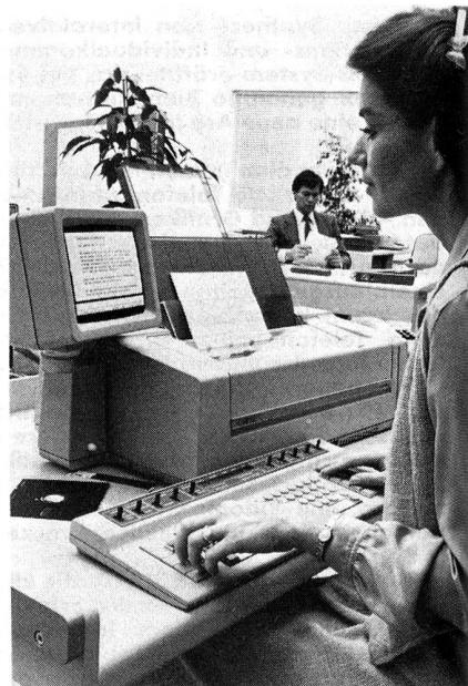
Sowohl als elektronische Schreibmaschine, elektronische Speicherschreibmaschine und vor allem als Übertragungsstation für die elektronische Textkommunikation können die neuen Textstationen von Siemens fungieren. Die für den von der Deutschen Bundespost geplanten Teletex-Dienst entwickelten Textstationen gibt es wahlweise mit Typen- oder Tintendruckwerk sowie mit oder ohne Bildschirmzusatz.
