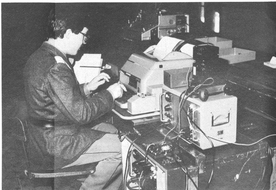
Die Fernschreiber Stg-100 – hier im KP der Sektion Zürich – waren via Mehrkanalteile MK 5/4 über Kleinrichtstrahl R-902 mit Schaffhausen verbunden.
