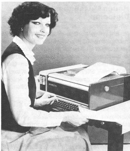
Der elektronische Fernschreiber F 1101 aus der DDR arbeitet als Matrixdrucker bis zu 100 Baud.
