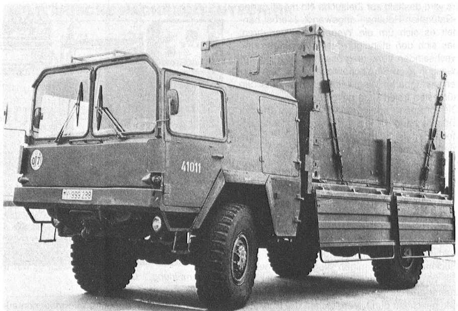
Teilnehmer im AUTOKO-Netz (Knotenvermittlung in Kabine, verlastet auf Lkw 4 t)
