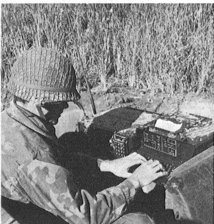
Der Synthesizer-Kurzwellen-Transceiver SC 106 von Southcom International weist eine Ausgangsleistung von 100 Watt PEP auf. Hier im Bild ist er mit dem Terminal SC 60 kombiniert.
