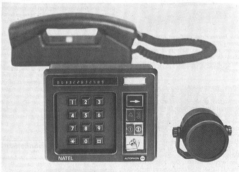
Das neue NATEL-Bedienungsgerät ist mit einem Nummernspeicher und einem Display ausgestattet. Im Bild sind auch die beiden andern Bedienelemente (Mikrotelefon und Lautsprecher) zu sehen.
