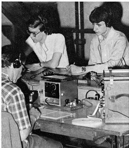
Im traditionellen Morsekurs (Kurstyp A) werden heute neben dem Streifenaufzeichnungsgerät (rechts im Bild) Kassettengeräte mit vorbereiteten Uebungstexten für das Gehöralesen eingesetzt. (Bild sp)
