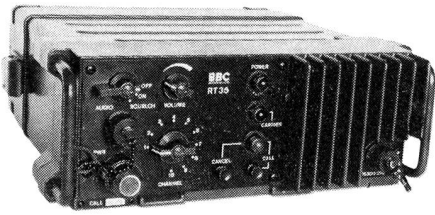
Das Universalgerät Veriphon® RT 35 ist für den Einbau von Sprachverschlüsselungszusätzen vorbereitet. (Bild BBC)
