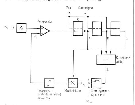
Abb. 2: Prinzip des CVSD-Codierers mit 3-bit-Koinzidenz E
