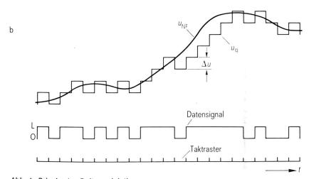
Abb. 1: Prinzip der Deltamodulation
