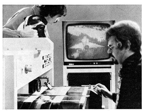
Das elektronische Auswertegerät REVI II: Im Vordergrund das Durchleuchtpult mit den Filmführungen, im Hintergrund der Bildmonitor
