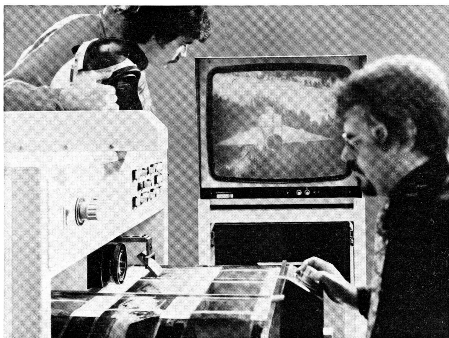
Das elektronische Auswertegerät REVI II: Im Vordergrund das Durchleucht-pult mit den Filmlührungen, im Hintergrund der Bildmonitor
