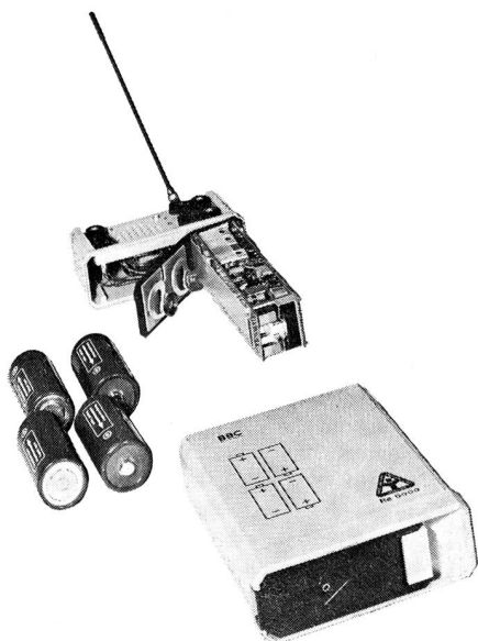
Bild 8: Innenansicht des Schutzraumempfängers
