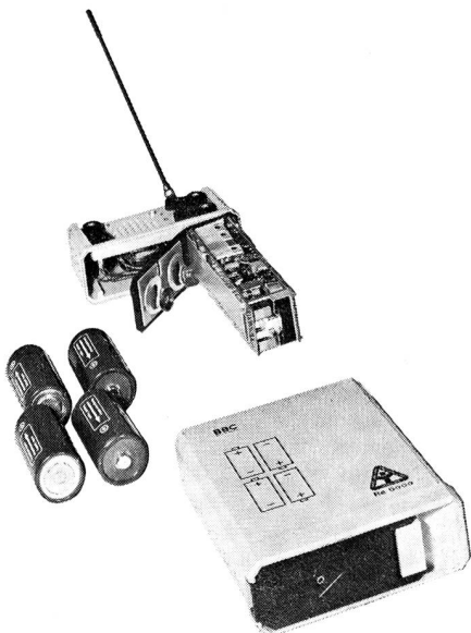
Bild 8: Innenansicht des Schutzraumempfängers
