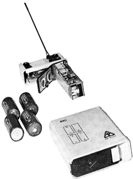
Bild 8: Innenansicht des Schutzraumempfängers
