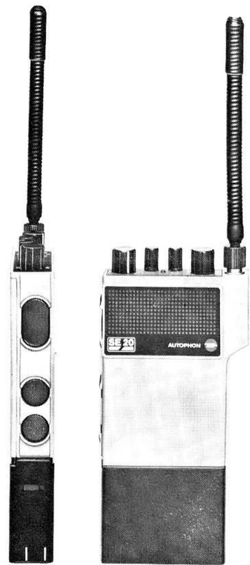
SE-20 von Autophon: Mit seinen Leistungsdaten zur Zeit das kleinste professionelle Handsprechfunkgerät
