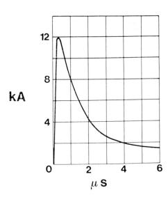
Figur 7: Eine Starkstromleitung bildet eine vortreffliche EMP-Antenne. Das Bild zeigt den Stromverlauf in Funktion der Zeit bei einem EMP-Impuls.
