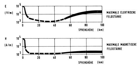
Figur 8: Feldstärke des EMP auf der Erdoberfläche in Funktion der Sprenghöhe
