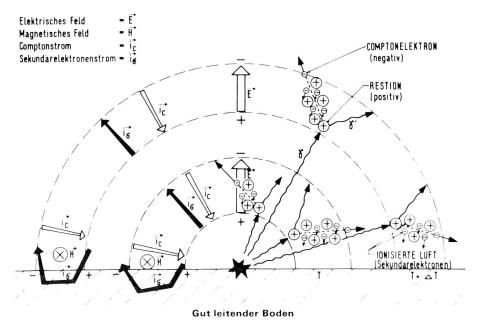
Figur 3: Comptonstrom und Sekundärelektronenstrom bei Bodenexplosionen
