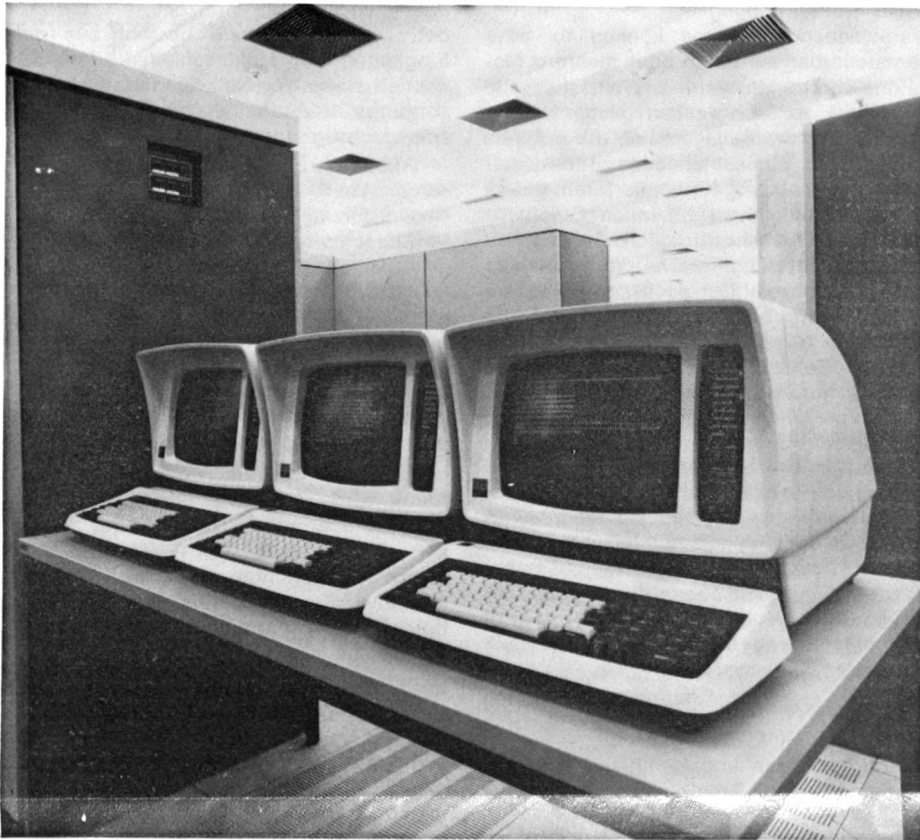
ITT Bildschirm-Terminals, die in der Robocom-Empfangszentrale als Bedienteil eingesetzt sind. Alarm und Steuerbefehle werden über fixgeschaltete Mietleitungen des Telefonnetzes übertragen. Jedem Alarm kann ein Text zugeordnet werden.
