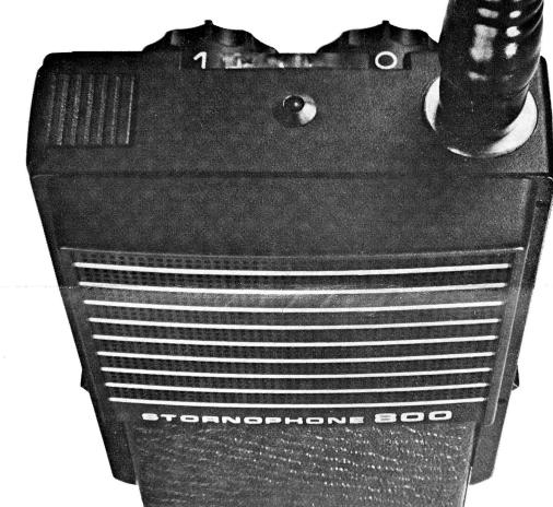
Stomophon 800 U, der modernste und universellste Handfunksprecher auf dem Weltmarkt. Aufgrund seiner hohen Ausgangsleistung von 3 Watt und seiner enormen Lautstärke ist es das ideale Gerät für den harten Einsatz. Die konsequent angewandte Dickfilmtechnik macht ihn zu einem robusten, wetterfesten und stoßunempfindlichen
