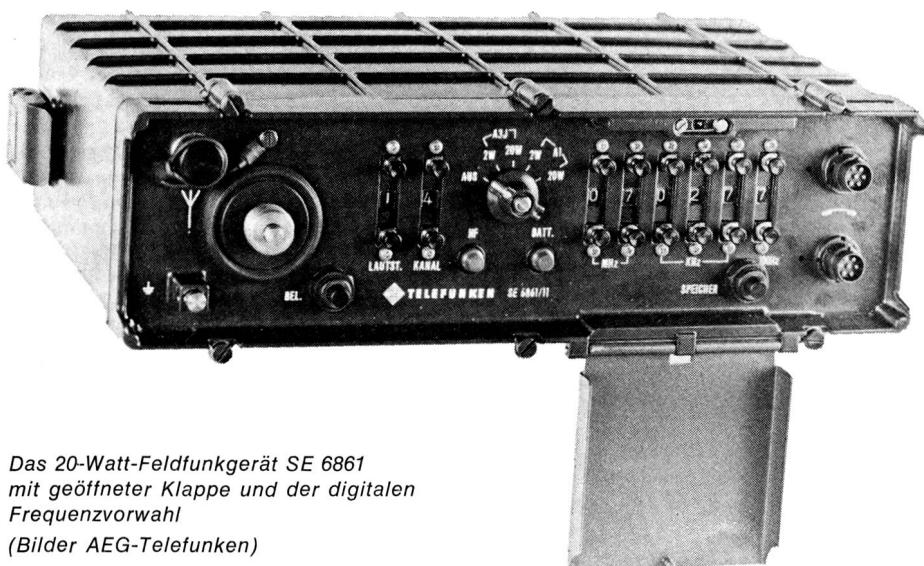
Das 20-Watt-Feldfunkgerät SE 6861 mit geöffneter Klappe und der digitalen Frequenzvorwahl
