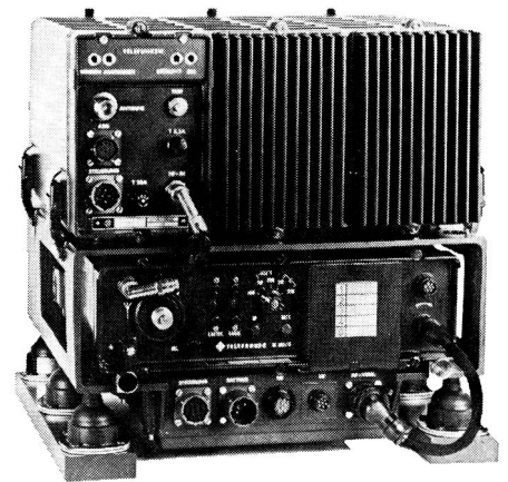
Das Feldfunkgerät SE 6861 in der Fahrzeughalterung und mit aufgesetztem Sendeverstärker SV 6863. Die Sendeleistung beträgt maximal 150 Watt.
