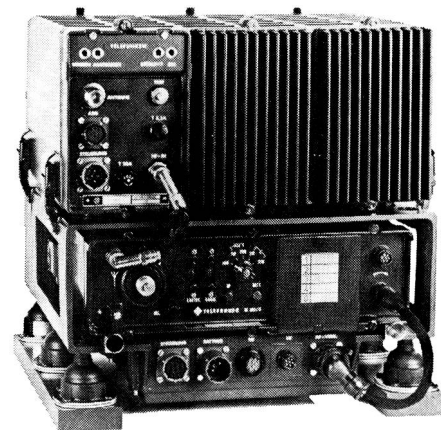
Das Feldfunkgerät SE 6861 in der Fahrzeughalterung und mit aufgesetztem Senderverstärker SV 6863. Die Sendeleistung beträgt maximal 150 Watt.
