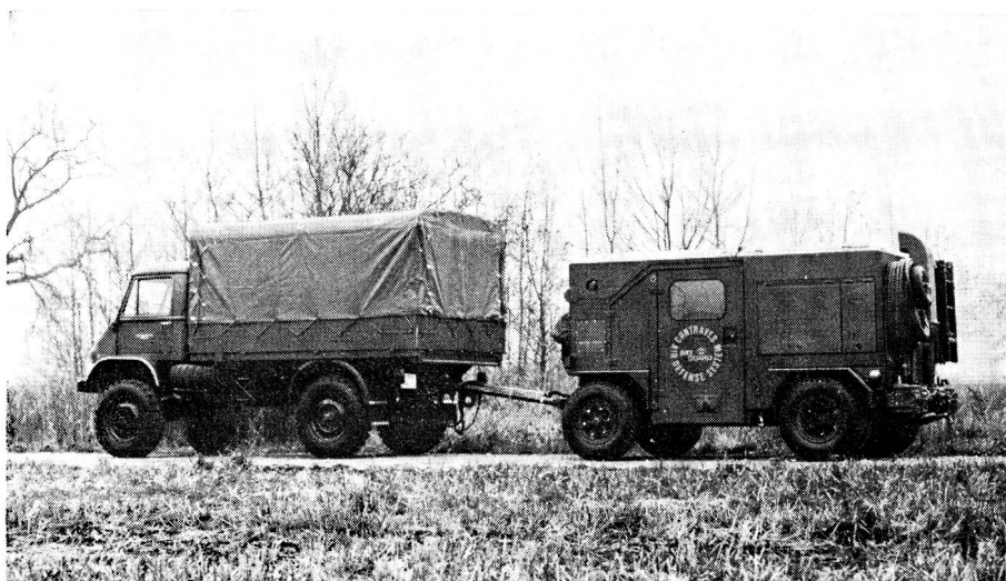
Skyguard — das kompakte, robuste und miniaturisierte Feuerleitsystem ist sehr mobil und schnell einsatzbereit. Für den Transport genügt ein Klein-LKW. Seine Aumessungen sind so klein gehalten, dass Bahn- und Lufttransportfähigkeiten gewährleistet sind.
