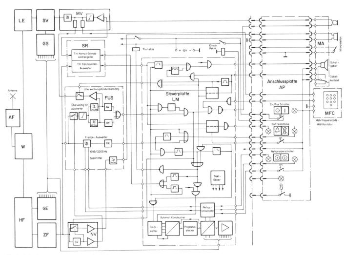
Fig. 9: Prinzipschema Mobilstation NATEL
