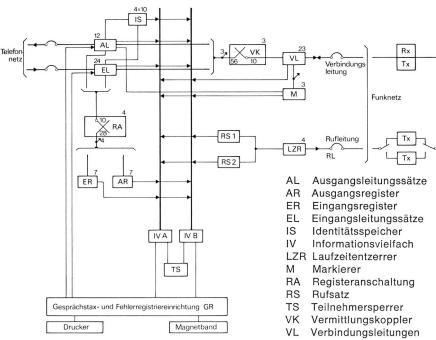
Fig. 5: Prinzipschema der Ruf- und Durchschaltezentrale
