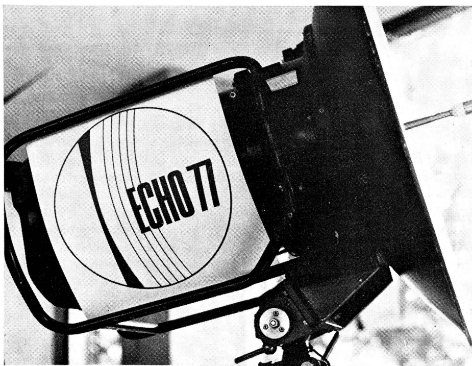
Die «Nabelschnur» jedes Uebermittlungszentrums bildeten die Richtstrahlzubringerstrecken zu den Höhenstandorten. Basel zeigte mit seinem Gerät gerade die Verknüpfung mit dem Signet der Übung ECHO 77. (Aufnahme Walter Fankhauser, Zentrum Basel)
