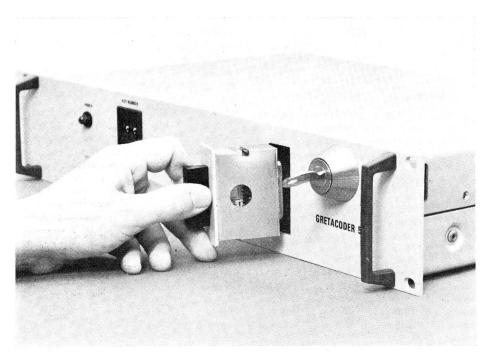
Bild 4: Die geheimen Schlüsselelemente, der Verknüpfungsschlüssel und 30 verschiedene Grundschlüssel werden vom Sicherheitsbeauftragten in einem Einschub programmiert, welcher im Gerät eingeschlossen wird.
