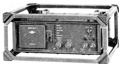
Die Verschlüsselung erfolgt durch Verknüpfung des Impulszuges mit einer intern erzeugten Schlüsselkette. Diese wird anhand einer eingespeisten, im Hauptspeicher gelagerten Grundschlüsselinformation laufend erzeugt. Der Schlüsselvorgang wird textabhängig beeinflusst, so dass ein nicht-rückrechenbares Resultat entsteht.
