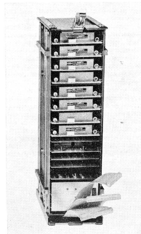
einer automatischen Zentrale aus eine Feldtelefonstation am fernen Ende anzu rufen. Speziell zu erwähnen ist die vierdrahtmässige, digitale Durchschaltmöglichkeit. Diese erweist sich in Knotenstellen oder für Uebermittlung von Datensignalen als sehr nützlich. Der konstruktive Aufbau entspricht dem MCC-314 (Fig. 5).
