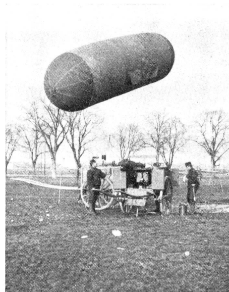
Funkversuche mit der Ballonantenne 1905 Essais de télégraphie sans fil avec antenne-ballon 1905
