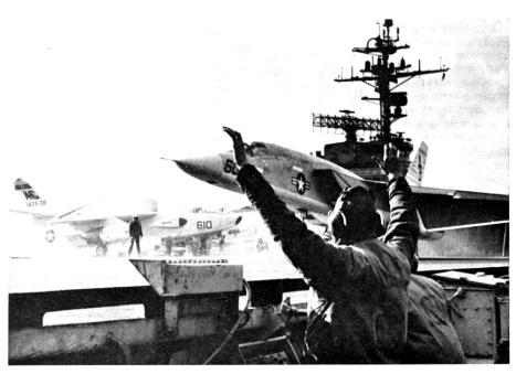
Ein Ueberschall-Fotoaufklärer des Typs RA-5C Vigilante ist auf einem Katapult startbereit. Der Matrose im Vordergrund verständigt sich mit Handzeichen mit dem hier nicht sichtbaren Katapultoffizier. Sobald ihm dieser das Auslösesignal gibt, wird er am Schaltpult einen Knopf drücken. Dadurch wird die Vigilante auf der nur 80 m langen Dampfkatapultbahn innert zwei Sekunden von 0 auf über 200 km/h beschleunigt und in die Luft befördert.
