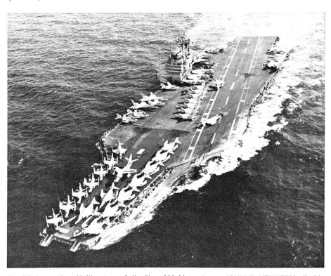
Ein Blick aus dem Helikopter auf die über 300 Meter lange JOHN F. KENNEDY, die bis zu 100 Flugzeuge mitführen kann. Deutlich ist die schräg zur Schiffslinie verlaufende Landebahn zu erkennen. Zwei Katapulte befinden sich im vorderen Teil des Flugdecks, zwei weitere sind in der Landebahn ersichtlich. Der Kommandoturm ist seitlich nach Steuerbord verschoben. Die vier Fünfblattschrauben der KENNEDY verleihen dem Koloss eine Maximalgeschwindigkeit von über 60 km/h.
