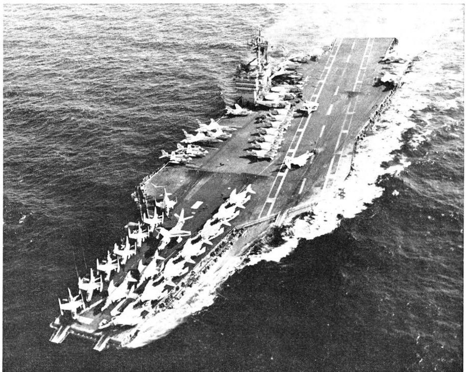
Ein Blick aus dem Helikopter auf die über 300 Meter lange JOHN F. KENNEDY, die bis zu 100 Flugzeuge mitführen kann. Deutlich ist die schräg zur Schiffslinie verlaufende Landebahn zu erkennen. Zwei Katapulte befinden sich im vorderen Teil des Flugdecks, zwei weitere sind in der Landebahn ersichtlich. Der Kommandoturm ist seitlich nach Steuerbord verschoben. Die vier Fünfblattschrauben der KENNEDY verleihen dem Koloss eine Maximalgeschwindigkeit von über 60 km/h.
