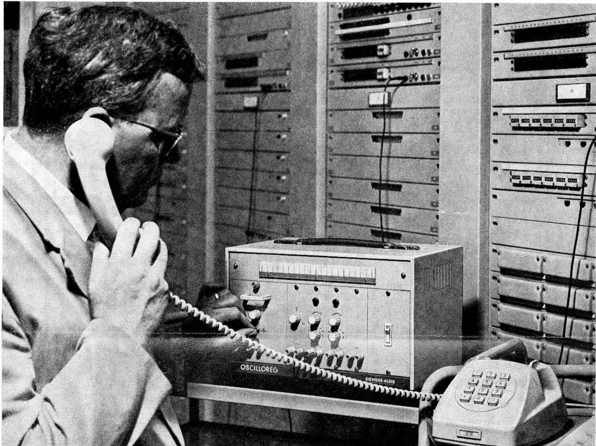
Der neue Dreikanal Metallpapier - Impulsschreiber mit optimaler Anpassungsfähigkeit - steckbare Modulbauweise - zwei Papiergeschwindigkeiten - drei Anlassarten - Auflösungsvermögen bis 1000 Hz. - leichte Auswertung der Schreibspuren hinter beleuchtetem Maßstab - Signallampe für Schreibbereitschaft - Netzanschlüsse 110/125/220 V, 50/60 Hz. umschaltbar.
