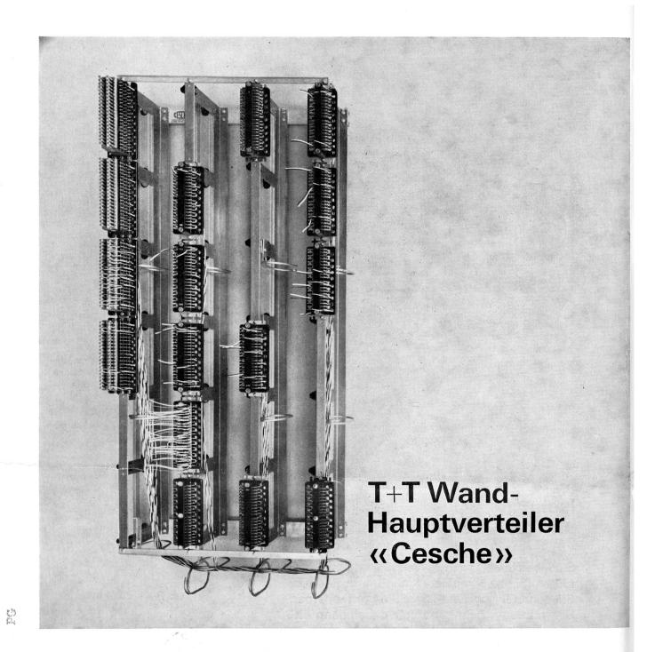
für rationelle Montage, Kabelführung in Kunstrur rationelle Montage, Kabelfuhrung in Kunst-stoffkanälen mit Austrittsöffnungen, PVC-Kabelbriden erübrigen das zeitraubende An-binden der Kabel G51, sämtliche Teile sind korrosionsbeständig, sie sind promatisiert, in Antikorodal oder in Kunststoff geschaffen, die Rangierringe sind regulierbar, nachstehende Typen sind ab Lager lieferbar
