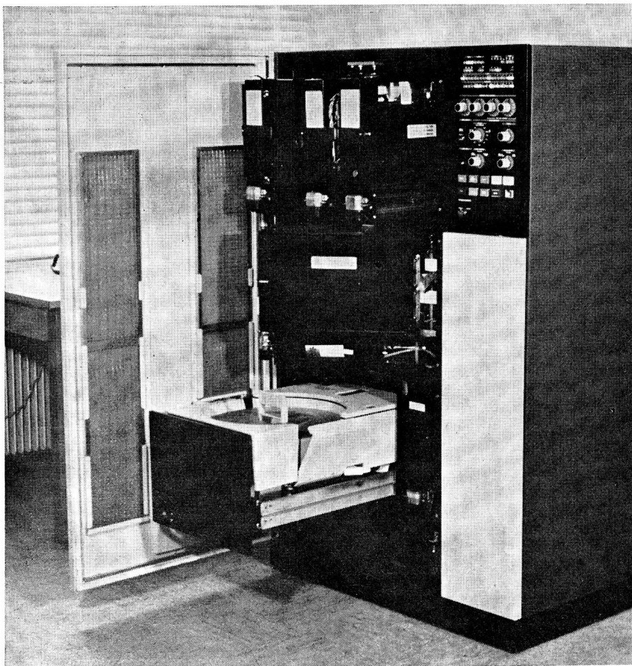
Computer: Oben: Rechner, Mitte Multifunktionsmodul, unten: Plattenspeicher
