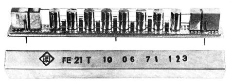
Abb. 2 Mechanische Kanalfilter mit Torsionsresonatoren
