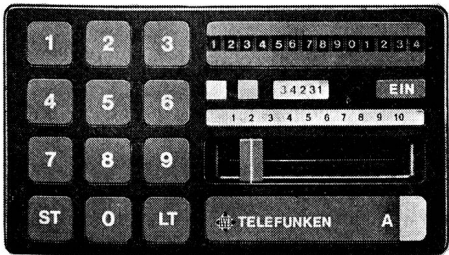
Fig. 2 Bedienplatte des Automatic-Auto-telephons S von AEG-Telefunken mit Tastenwahl und Speichermöglichkeit der anzurufenden Ortskennzahl und Teilnehmernummer. Um Fehlverbindungen zu verhindern, ist die gewählte Nummer sichtbar (oben rechts). Anrufe bei Abwesenheit des Teilnehmers werden durch eine Lampe angezeigt (unten rechts).
