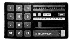
Fig. 2 Bedienplatte des Automatic-Autotelephons S von AEG-Telefunken mit Tastenwahl und Speichermöglichkeit der anzurufenden Ortskennzahl und Teilnehmernummer. Um Fehlverbindungen zu verhindern, ist die gewählte Nummer sichtbar (oben rechts). Anrufe bei Abwesenheit des Teilnehmers werden durch eine Lampe angezeigt (unten rechts).
