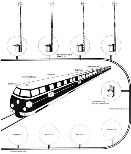
Schematische Darstellung des Systems Zugbahnfunk
