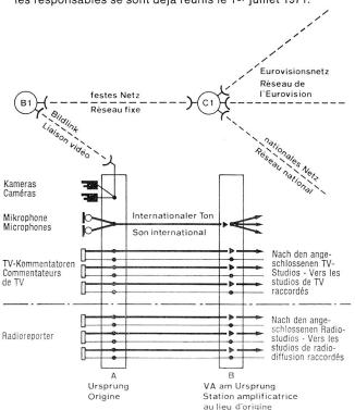
Fig. 5 Retransmissions radiophoniques et télévisuelles d'une importante manifestation.
