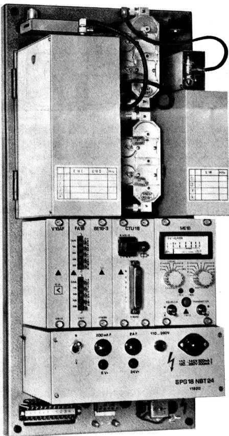
Die ortsfeste Sprechfunkanlage SE 18 HFT Sie wird als Netzleit-, Relais- oder Unterstation verwendet oder kann als drahtlose Telefonleitung dienen. Sie enthält einen Sender und zwei Empfänger mit 1 ... 4 Kanälen, einen universellen Speiseteil sowie einen Messzusatz, mit dem alle wesentlichen Funktionen der Anlage geprüft werden können. Zur leichteren Wartung sind alle Teile ausdrehbar.
