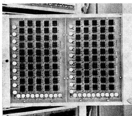
Kondensatorplatte auf Rückseite der Zählerbüchse
