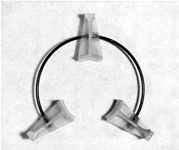
Drei Elemente aus Du Pont-Teflon-FEP-Fluorkunststoff werden auf einem offenen kupferplattierten Stahlring in einem einzigen Arbeitsvorgang gegossen. FEP widersteht der Höchsttemperatur des Koaxialkabel-Innenleiters in der neuen Sendeanlage der «Deutschen Welle». Sie beträgt 140 °C.
