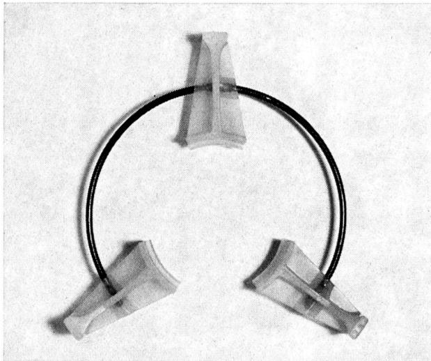
Drei Elemente aus Du Pont-Teflon-FEP-Fluorkunststoff werden auf einem offenen kupferplattierten Stahlring in einem einzigen Arbeitsvorgang gegossen. FEP widersteht der Höchsttemperatur des Koaxialkabel-Innenleiters in der neuen Sendeanlage der «Deutschen Welle». Sie beträgt 140 °C.
